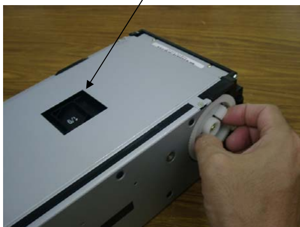
① ハンドルを回転させスロットを合わせます
