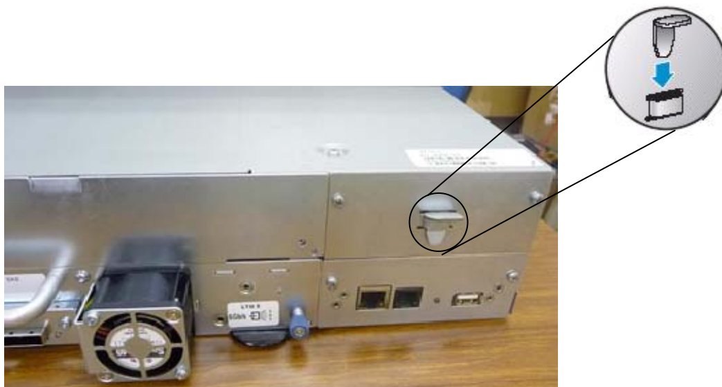
搬送用ロック保管図（L1／24テープライブラリの例）
