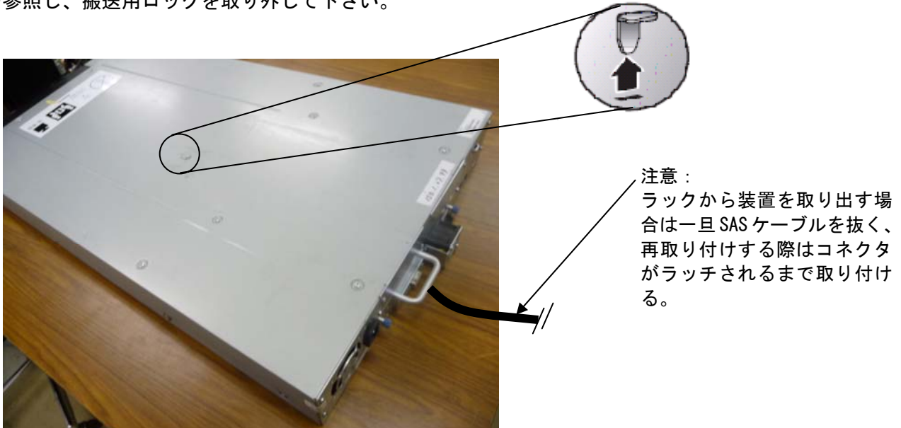
搬送用ロック取り外し図（L1/24テープライブラリの例）
