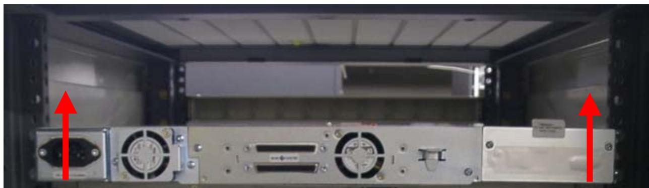
ラックに搭載したら装置背面側の両端を手で軽く持ち上げて装置が固定されていることを確認して下さい。
