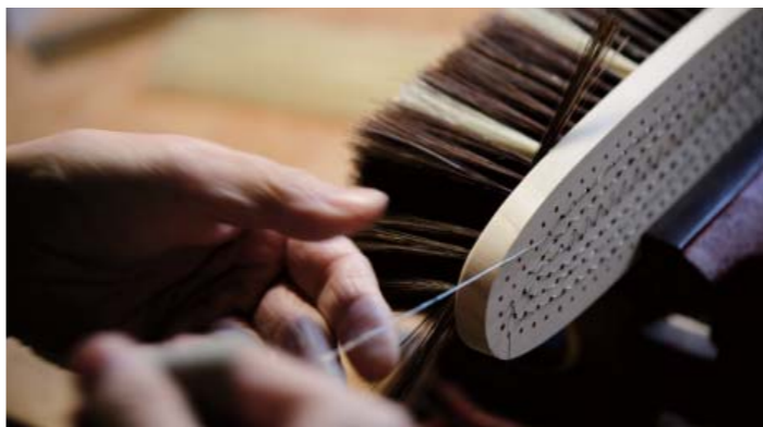
別方向に向いた毛は、ワイヤーを引っ張るとVの字になり、穴に収まる。
