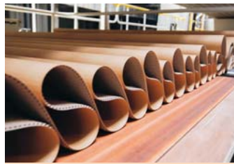
波形の中しんとライナ(原紙)によって片面段ボールがつくれた後、もう1枚ライナを貼り合わせて段ボールシートが完成します
