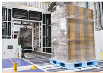
出来上がった段ボール製品は、自動搬送機によってラック式免震自動製品倉庫に運ばれます
