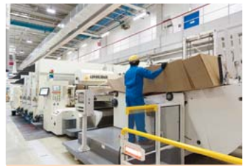
1分間に400枚という世界最速を誇る機械をはじめ、製函工程の設備も高品質な製品づくりを支えています
