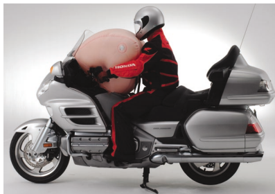
Hondaが開発した二輪車 用エアバック(展開状態)
