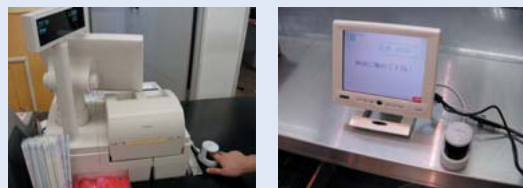
日立製作所内売店のPOSレジにおける指静脈マネー決済の様子 社員食堂における指静脈マネー決済用無人端末
