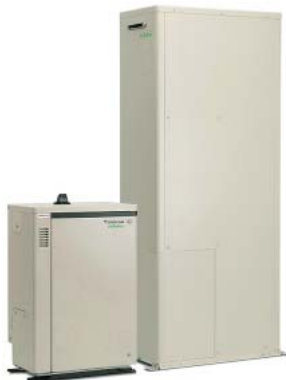
1kW家庭用ガスエンジンコージェネレーションシステム「ECOWILL(エコウィル)」は、都市ガスを使ってガスエンジンを動かして発電すると同時に、排熱を利用してお湯を作り、給湯や暖房に利用する。高効率な運転で快適かつ、エコロジーで経済的な生活を支援する。
