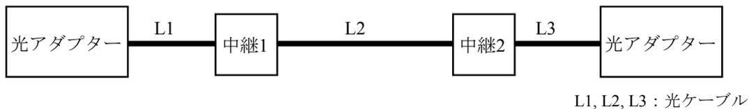
図3-5 1光区間内の光ケーブル構成例
