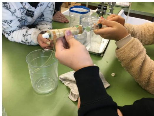
MF(Microfiltration Membrane)膜を使用したろ過実験
