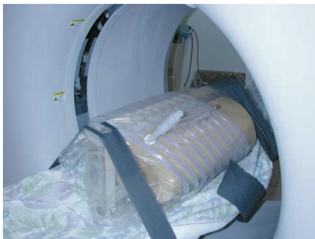
図6：穿刺訓練ファントム 胸部を模してアクリルを用いて作成した。
