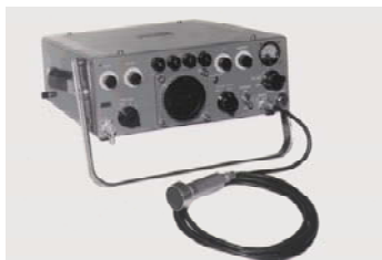
世界初のAモード超音波診断装置
