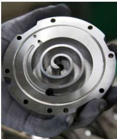
高い工作精度が要求される渦巻き形スクロール
