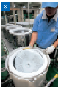
外槽にバスケットとビートウィングをはめ込む。
