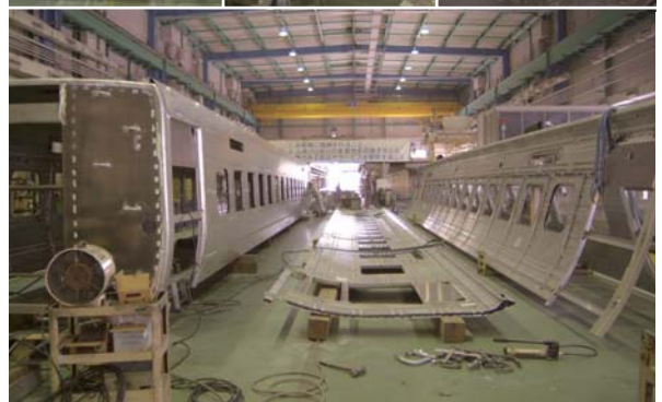
在来線の車体の組み立て工程。写真 秋山由樹
