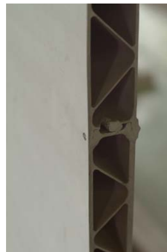
700系車両から採用されたダブルスキン構造。これを縫ぎ目の 出ないFSW摩擦攪拌接合で溶接していく。写真 秋山由樹
