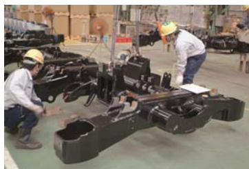
新幹線の台車枠(車軸を支える部分)。
