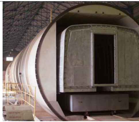
気密疲労試験装置。直径5m、長さ30mの筒に車体を密封、 気圧変動を繰り返して疲労亀裂を洗い出す( 笠戸事業所 )。 写真 秋山由樹
