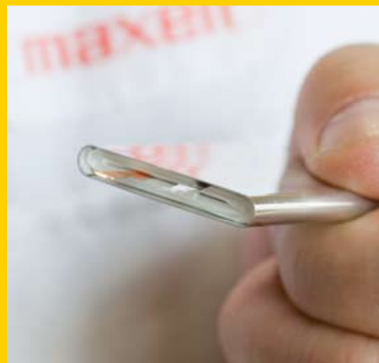
リチウムイオン電池のケースはアルミニウムの絞り加工。写真の製品は、厚さ約4.5mm。
