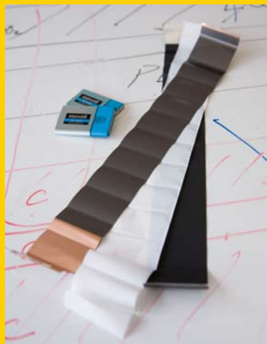
リチウムイオン電池の中身。下からアルミ箔に塗布された二酸化コバルトリチウム（正極）、セパレータのポリエチレン、銅箔に塗布された炭素（負極）。この三重構造が幾重にも巻かれて、ケースに納められる。
