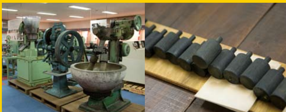
日立マクセル株式会社京都事業所には、創業当時のマンガン乾電池の生産設備が保存されている。
