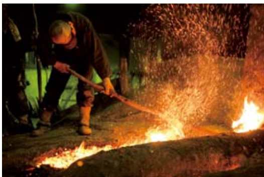
湯路穴から出てきたノロ（鉄滓）をかき出す。ノロの出具合も、銅の出来を占う要素の一つ。
