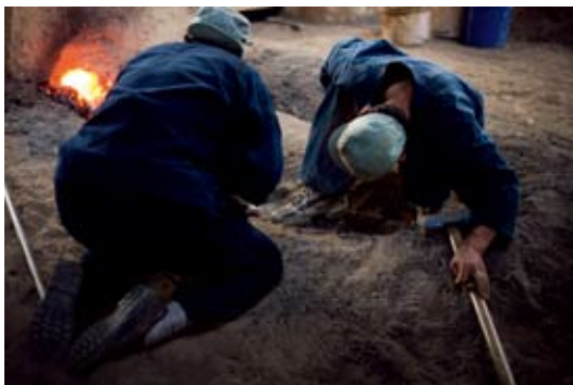
日刀保たたらでは、砂鉄から直接銅をつくる「銅押し法」で玉銅をつくる。砂鉄の加減と炉の温度管理がその出来を左右するという。
