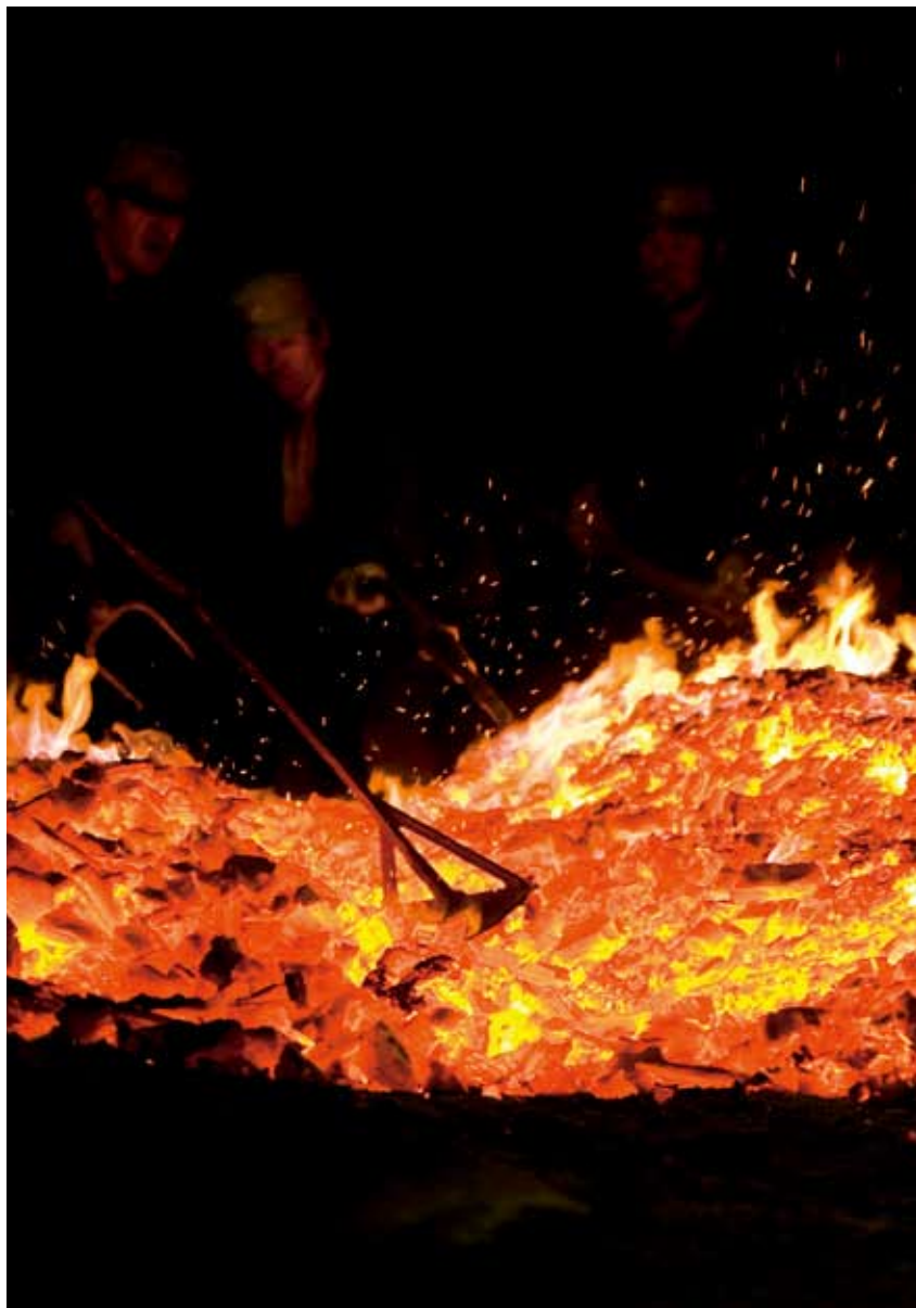
三日目の早朝、吹子を止め、銅を取り出すために作業者全員で炉を崩し始めた。中から3.5tの銅の塊（銅）が顔をのぞかせる。たたら吹きクライマックスである。
