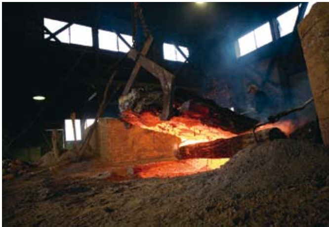
「鋳引き」の様子。まだ赤く焼けた状態の鋳にチェーンを巻きつけ、小屋の外に引っ張り出す。
