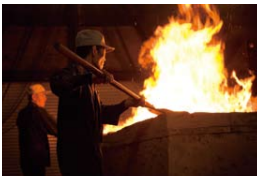
炉に砂鉄をくべる木原村下（手前）と渡部村下（奥）。村下は表（手前）と裏（奥）に一人ずつで、表と裏それぞれの状態を、担当の村下が見極めながら作業を行う。
