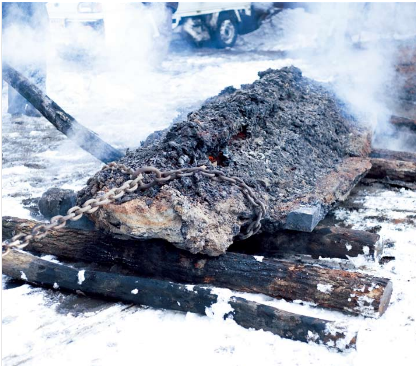
屋外に引っ張り出された鋤。このうち、日本刀の原料となる良質の玉鋼は、わずか1tしか取り出すことができない。
