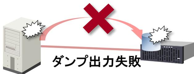
ダンプディスクで障害が発生するとダンプ採取不可
