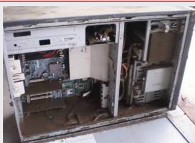
汚泥が貼りついたサーバ内部
