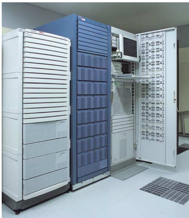
システム情報学センター内に設置されたHA8000-ex/880。左にあるブルーの筐体は、4Tバイトの大容量ディスクを備えたSANRISE1200
