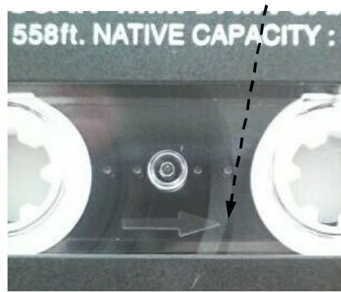
(テープのゆるみが発生した状態)
