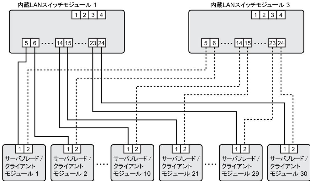
上記は、サーバブレード / クライアントモジュール 1 ~ 10、21 ~ 30 と内蔵 LAN スイッチモジュール 1、3 の接続を示しています。これと同様に、サーバブレード / クライアントモジュール 11 ~ 20、31 ~ 40 は内蔵 LAN スイッチモジュール 2、4 に接続されます。
