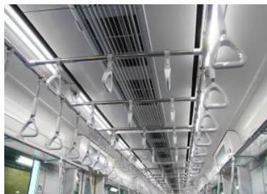
吊り手の増設
