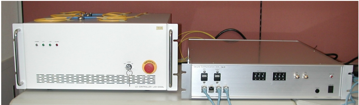
試作したセキュア通信装置。本体(右)及びノイズ発生器(左)からなる。
