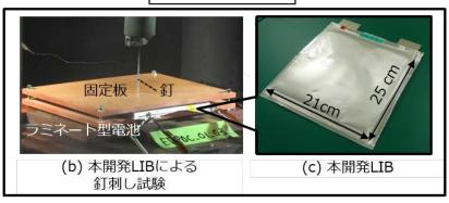
株式会社日立製作所(執行役社長兼 CEO:東原 敏昭/以下、日立)と国立大学法人東北大学 (総長:里見 進/以下、東北大学)多元物質科学研究所(IMRAM)の本間 格教授らの研究グループは、従来の有機電解液よりも引火点が高く、燃えにくい新規電解質を用いた高安全なリチウムイオン二次電池(以下、LIB)の試作に成功しました。容量 100Wh のラミネート型電池\*1を用いて充電や放電などの電池特性を確認し、さらに、従来の有機電解液 LIB では発火に至る 釘刺し試験\*2 において、試作した LIB の不燃性を実証しました。本技術により、安全性を確保しつつ、車載や民生用途向けなどの LIB の高容量化、高エネルギー密度化が可能となります。
