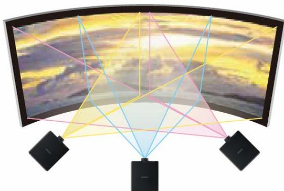
「エッジブレンディング」機能と「ワーピング」機能<sup>\*2</sup>を使った複数台のプロジェクターの投写映像(イメージ)
