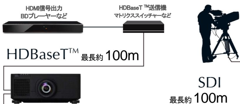
HDBaseT 入力端子および SDI 入力端子との機器接続例
