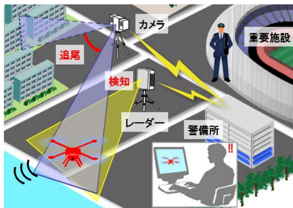
図:ドローン検知システムの運用イメージ
