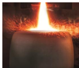
[図 2 内釜の溶射イメージ]
