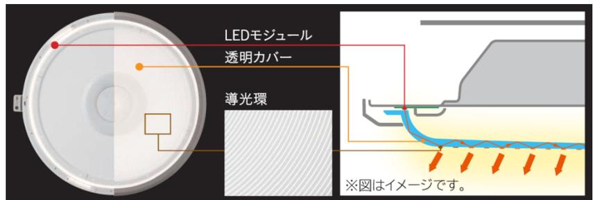
[図 2 「クリアライティング・テクノロジー」の構造と光り方]
