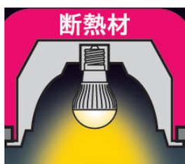
[図 2 断熱材施工器具装着イメージ図]
