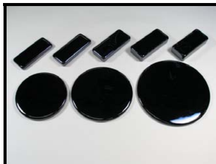
【写真】今回開発した鉛フリーバナジウム系低融点ガラス
