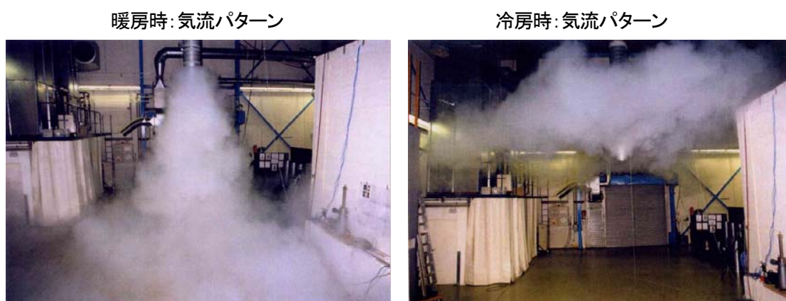
図 5. 置換換気空調用吹き出し口の冷暖房時の気流パターンの切り替え例
