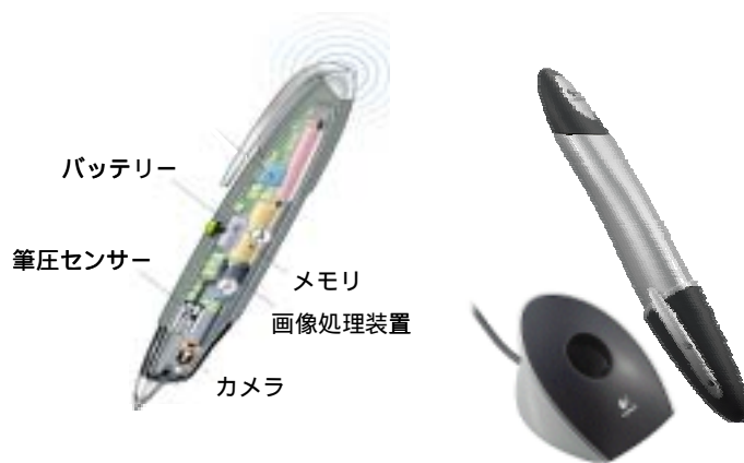
図2 . デジタルペンの構造 (左 : Bluetooth™搭載のペン、右 : USB 接続のペン)
