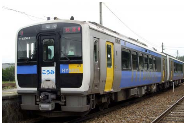
図 2.3 ハイブリッド駆動システムを搭載した JR東日本のキハ E200 形気動車
