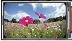
日立ディスプレイズの 携帯電話用 ワンセグ対応 3.2型ワイド IPS液晶ディスプレイ
