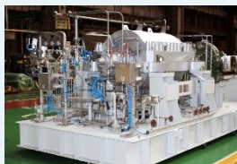
アンモニアプラント用圧縮機
