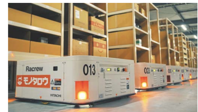
MonotaROの笠間ディストリビューションセンターで稼働中の小型無人搬送ロボット「Racrew」
